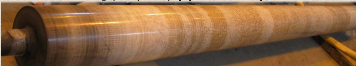
浮法玻璃生产线上的提升辊（使用后 1 年后） Lift-out rolls for float glass line (after one year service)
